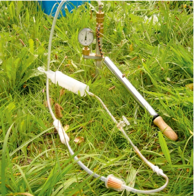
Beprobung der Bodenluft mit einer 1 Meter-Packersonde zur Ermittlung der Radonkonzentration in der Bodenluft. Quelle: Staatliche Betriebsgesellschaft für Umwelt und Landwirtschaft (BfUL)
