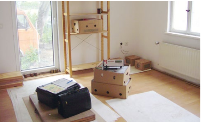
Radonmessung mit einem Radonmonitor in einem Neubau
